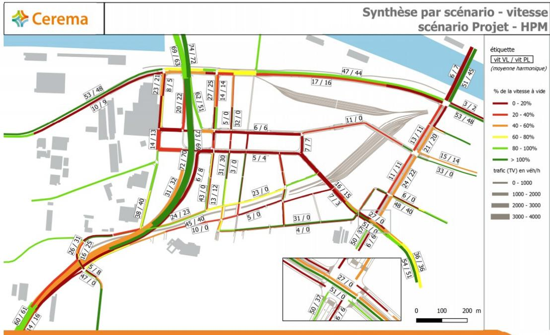
Figure 36 – Scénario projet optimisé – HPM - Carte des vitesses avec rapport à la vitesse à vide
