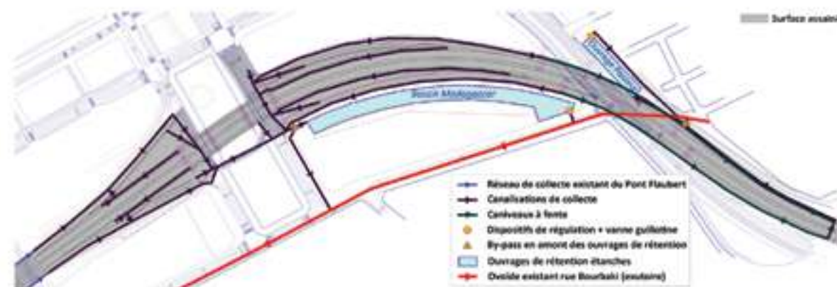
Figure 13 - Réseau d'assainissement pluvial du projet (DIRNO - 2015)
