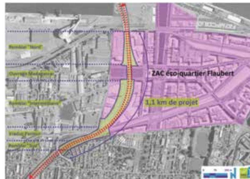
➡ Schéma 4 : Raccordements futurs du pont Flaubert à la Sud III en rive gauche de Seine (ORTHO IGN - 2012)
