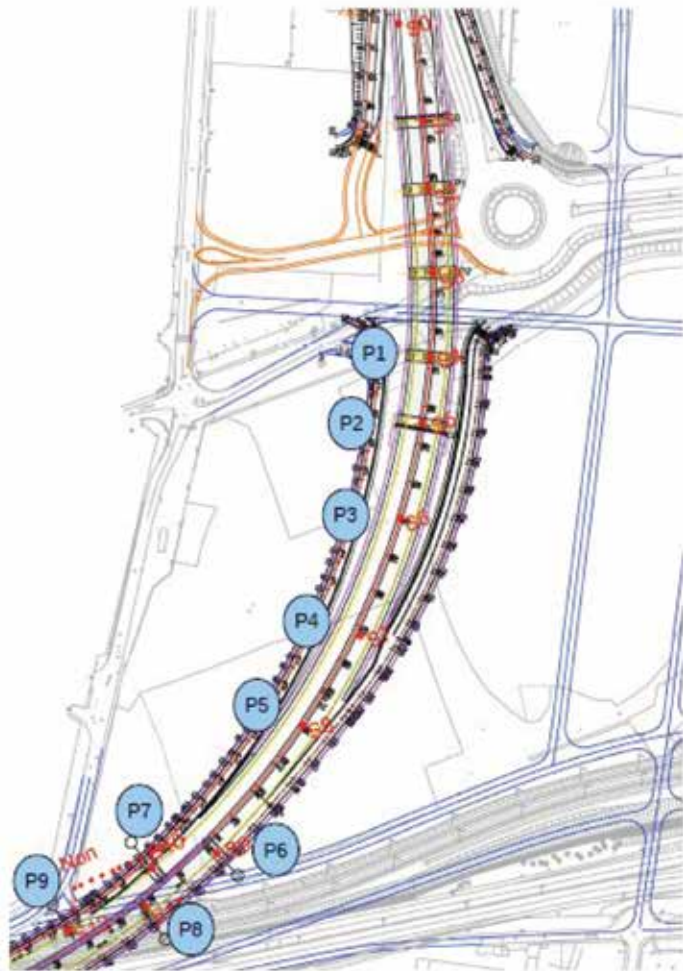
Illustration 4 : Implantation des points de prélèvements de gaz du sol
