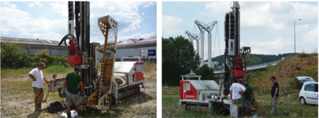
Figure 4 : Exemple de prélèvements à la tarière continue
