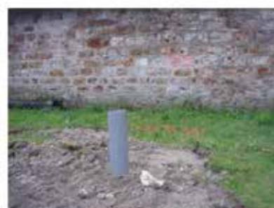
Sondage avec tube PVC en 80 mm
