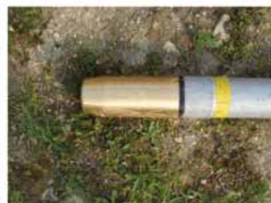
Lest amagnétique en bas de sonde
