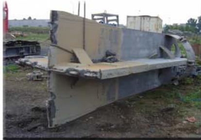
Le trépan de 11 tonnes, lâché à l'intérieur des tubes, permet de détruire la partie superficielle du terrain.
