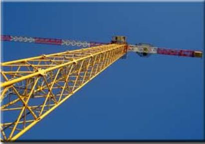
La grue à tour de 73 m de hauteur sous crochet possède une flèche de 100 m. Elle sera prochainement équipée d'un ascenseur.
