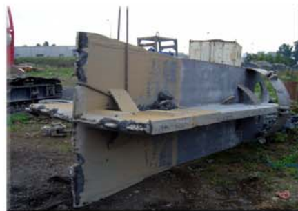
Trépan servant à fracturer les matériaux en fond de fouille des pieux d'un diamètre d'1,80 m
