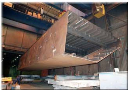
Demi-caisson, en cours de déplacement dans l'atelier
