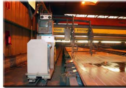
Traçage automatique de l'emplacement des augets (raidisseurs métalliques)
