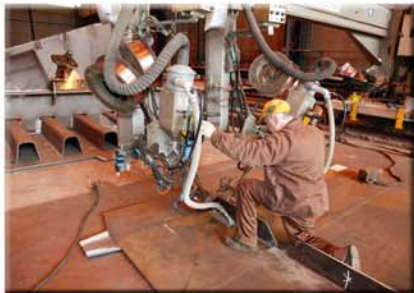
Outil de soudure automatique
